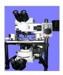
近场扫描光学显微镜(NSOM).系列产品在提供高分辨率光学信息的同时,也能测量到高分辨率的表面形貌。在扫描探针显微镜中锥形光纤探针作为主要的探头可以传送或收集光学信号,可以实现多种近场工作模式,包括收集,反射和透射模式。Nanonics 根据客户的需求提供不同的反馈机制系统和定制任何形状和几何尺寸的探头。
