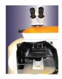
原子力显微镜拉曼光谱联用/针尖增强拉曼光谱(TERS). 此项技术能通过拉曼光谱提供样品高分辨率的化学成分信息,同时具有高分辨率的表面形貌。这些测试可以通过 AFM/共焦显微拉曼系统,或高分辨率的特制针尖增强拉曼光谱(TERS)系统实现。TERS 功能利用 SPM 针尖作为天线将光聚焦到针尖的正下方并收集高定位区域的拉曼光谱。
